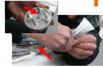
Limpiar y aislar con silicona
